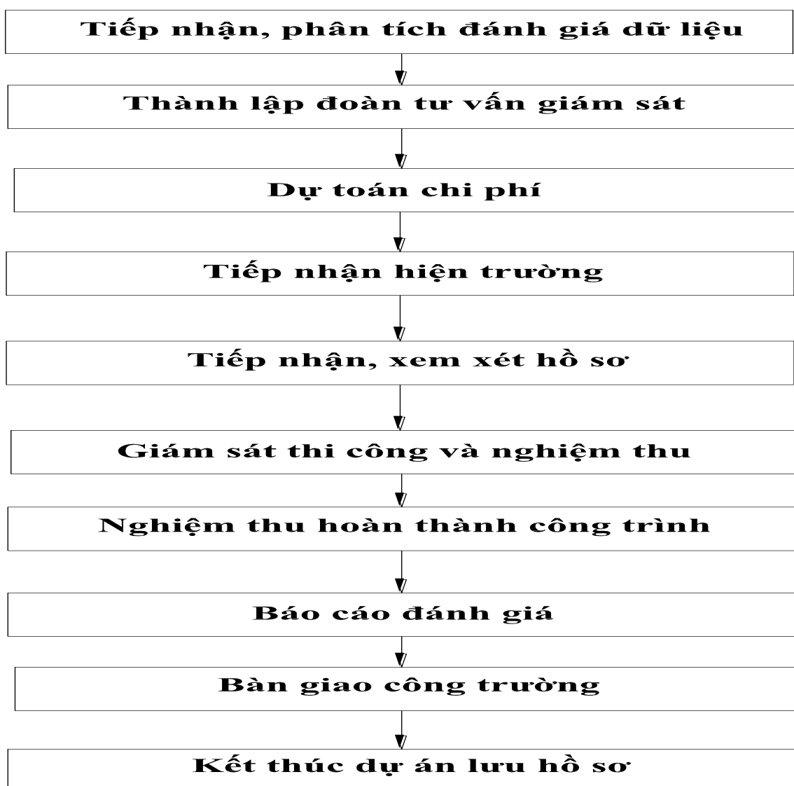
Hình 2.4 Sơ đồ quản lý chất lượng trong khâu thi công, kiểm tra, nghiệm thu và giám sát
