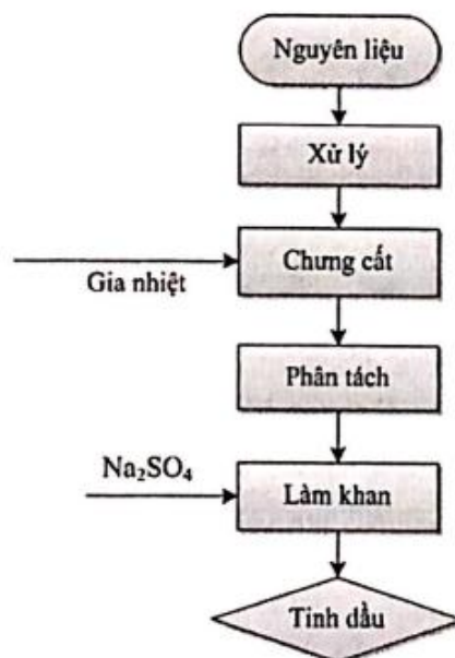
Hình 1. Sơ đồ chưng cất tinh dầu
