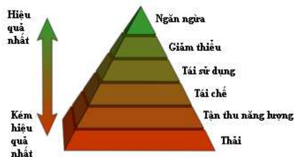
Hình 1.1. Hệ thống thứ bậc phân cấp về chất thải
