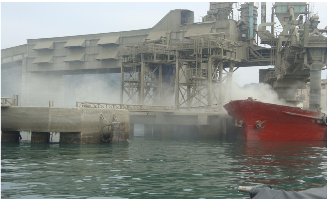
Bốc rớt clinker gây ô nhiễm môi trường tại nhà máy Xi măng Cẩm Phả năm 2013
