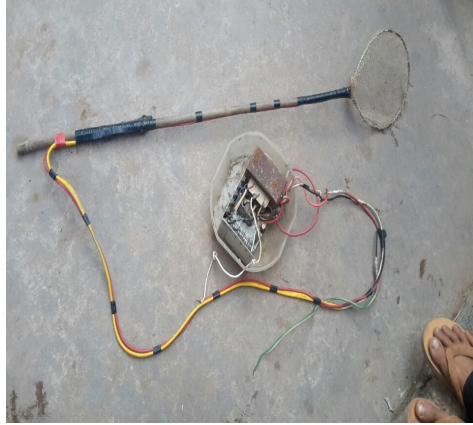
Hình 3.12: Kịch điện tự chế và lò bắt quái để khai thác thủy sản
